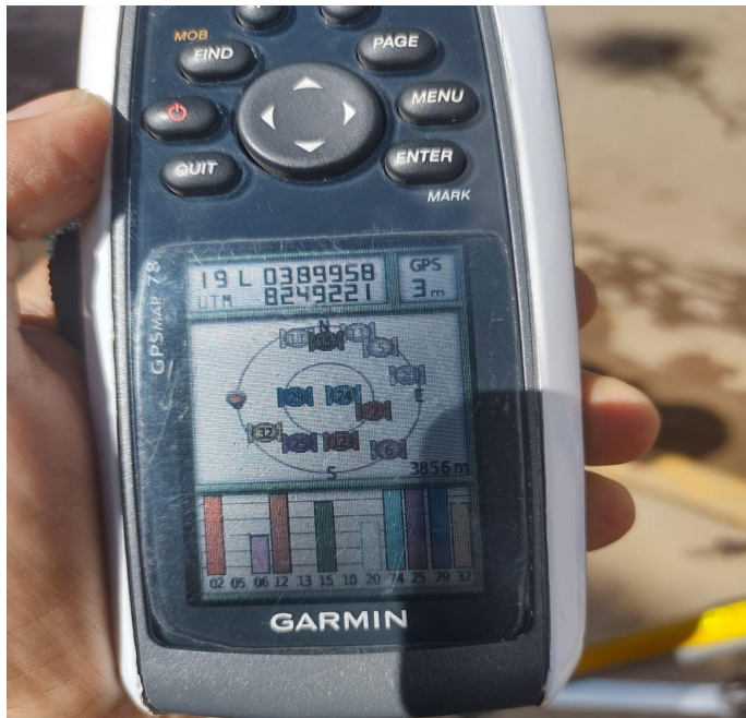
Figura 25: Identificación de las coordenadas Este (X) y Norte (Y), Punto 09 (Intersección Av. Floral con Av. la Torre), GPS marca GARMIN Modelo MAP78.
