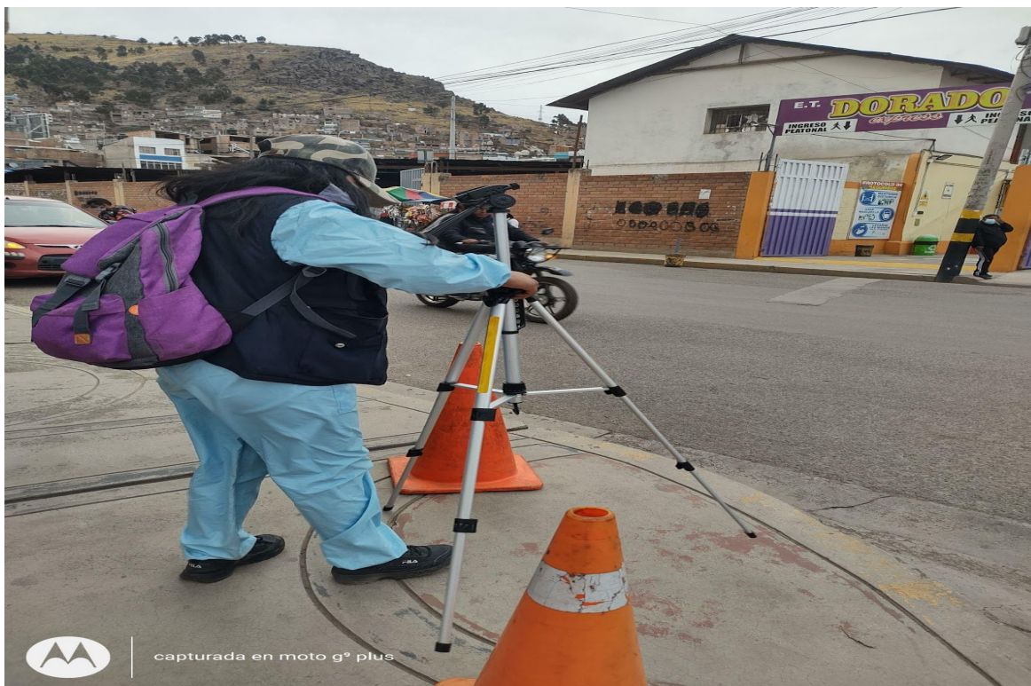
Figura 28: Instalación del trípode en el punto fijo de medición, Puno 8 (Intersección Jr. Lampa con Jr. Ilo).
