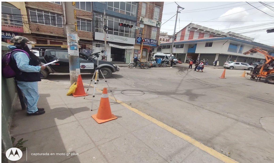
Figura 30: Instalación de los equipos, el sonómetro a una distancia de 0.5 metros del cuerpo del monitorista y 3 m de las paredes, construcción y estructura reflectantes, Puno 9 (Intersección Av. Floral con Av. la Torre).
