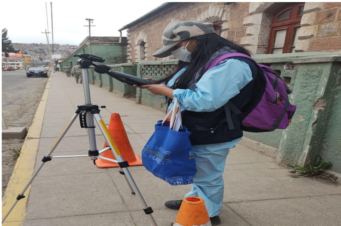
Figura 26: Configuración del sonómetro a escala A, (lectura en dB(A), Punto 06 (Intersección Jr. Oquendo con Av. la Torre).
